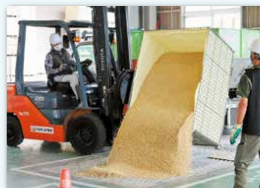
▲ホッパーに荷受けした麦を投入する作業員
