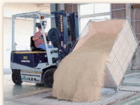
▲ホッパーに荷受けした麦を投入する作業員
